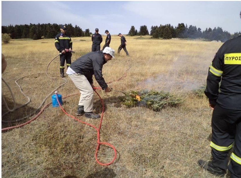
Δοκιμή ελεγχόμενης καύσης με φλόγιστρο υδραυλικού με μεγάλη φιάλη.
